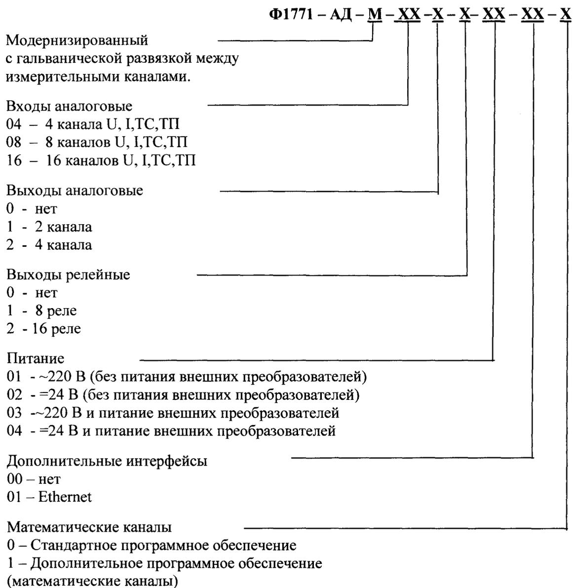
Примечание: для исполнений прибора без гальванической развязки буква «М» в обозначении не указывается.
